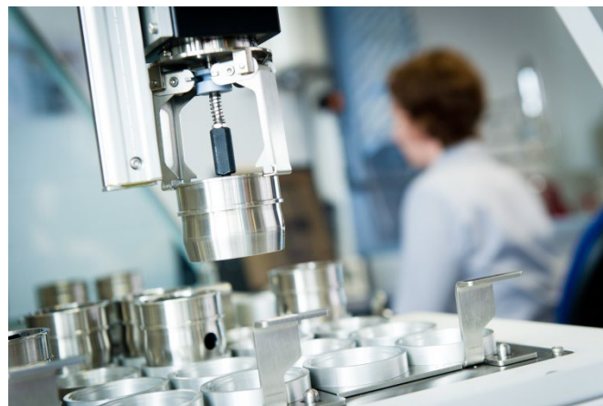
Analyse par fluorescence X : Passeur automatique d'échantillons
