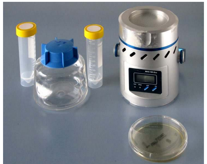
Gerätschaften zur Entnahme von Proben für die Wasseranalyse und bakterielle Raumluft-Messung
