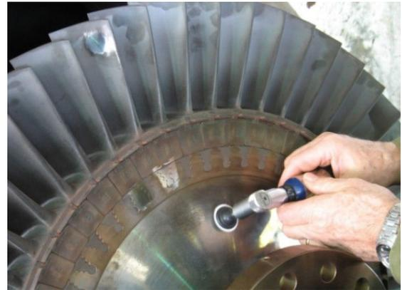
Ambulante Metallografie an einer stationären Gasturbine
