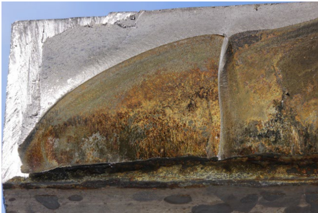
Schwingbruch im Zylinderblock eines Gaskompressors, ausgehend von einem Korrosionsangriff im Kühlwasserkanal (Makrofotografie)
