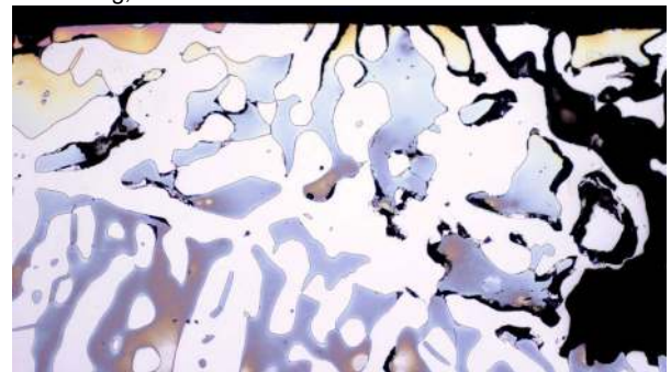
Selektive Korrosion an einem Pumpengehäuse aus Duplexstahl in einer Rauchgasreinigungsanlage (Lichtmikroskopie)
