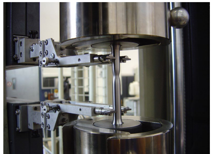
Zugversuch an einer SLM Rundprobe
