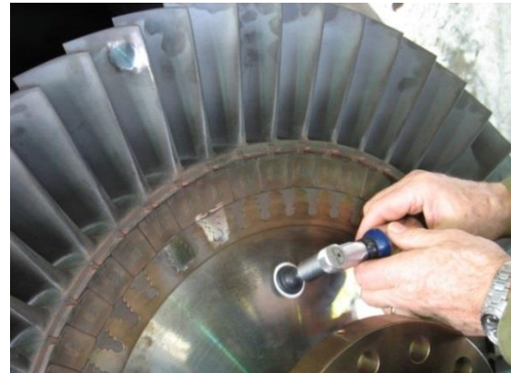
Ambulante Metallografie an einer stationären Gasturbine
